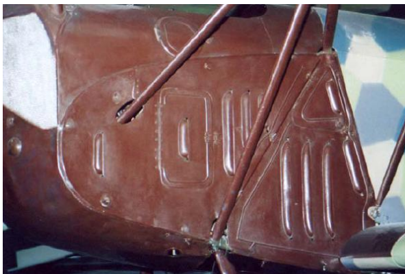
Rys. 15 Zdjęcie ilustrujące żaluzje w maskach silnika samolotu Fokker D.VII
