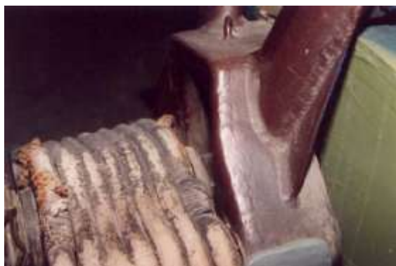
Rys. 52 Zdjęcie elementu amortyzującego podwozia w samolocie Fokker D.VII
