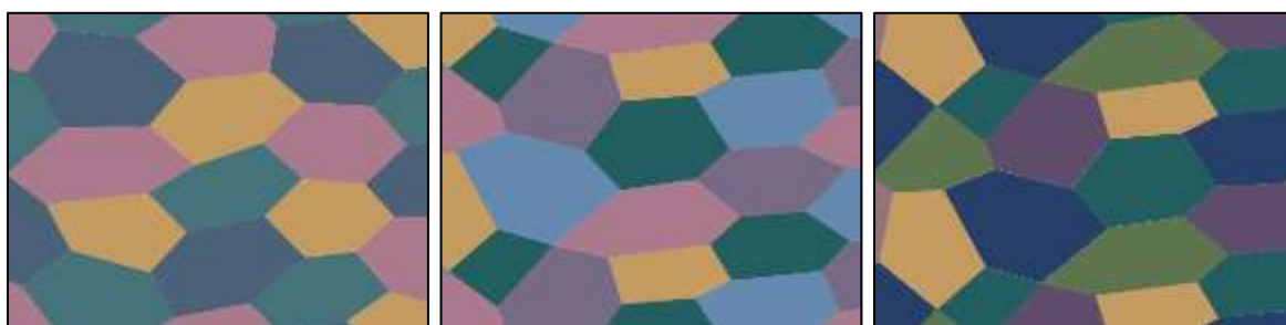
Rys. 81 Ogólny widok wzoru lozenge (od lewej: 4D wzór 4-barwny - kadłub, 5D wzór 5-barwny - spód skrzydeł, 5G wzór 5-barwny - góra skrzydeł) na samolocie Fokker D.VII
