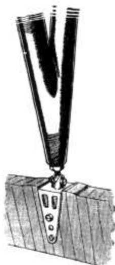
Rys. 37 Mocowanie zastrzału do dźwigara dolnego skrzydła samolotu Fokker D.VII
