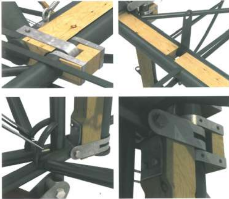
Rys. 48 Zawiasy w układzie przeniesienia napędu na powierzchnię sterowe w samolocie Fokker D.VII
