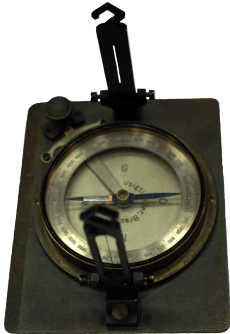
Niemiecki kompas wojskowy artylerii z I wojny światowej, w mosiężnej obudowie z pokrywą ochronną, z podziałką i składanym zamknięciem. - zakup antykwareczny
